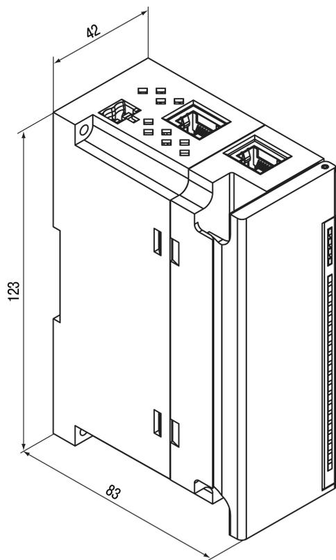
Рисунок 4.3 – Габаритный чертеж
