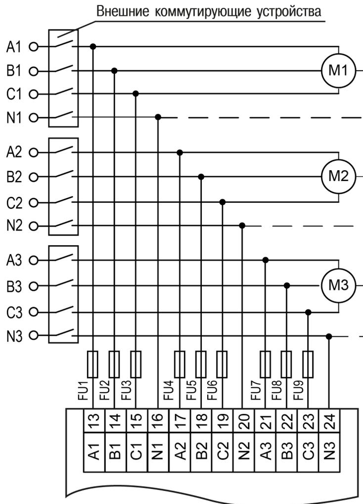
FU1–FU9 — плавкие предохранители 1,0 А/600 В (типа ВПТ 6–33)
