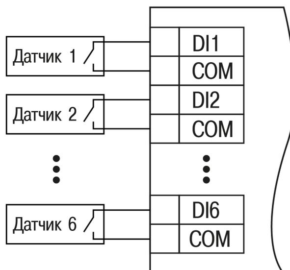
Рисунок 5.4 – Схема подключения к входам DI1–DI6 прибора
