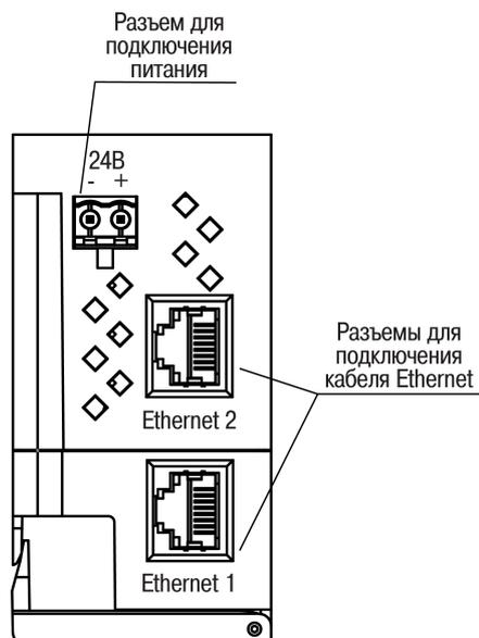
Рисунок 5.2 – Разъемы прибора
