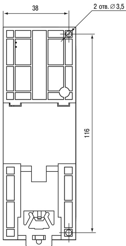
Рисунок 4.4 – Установочные размеры
