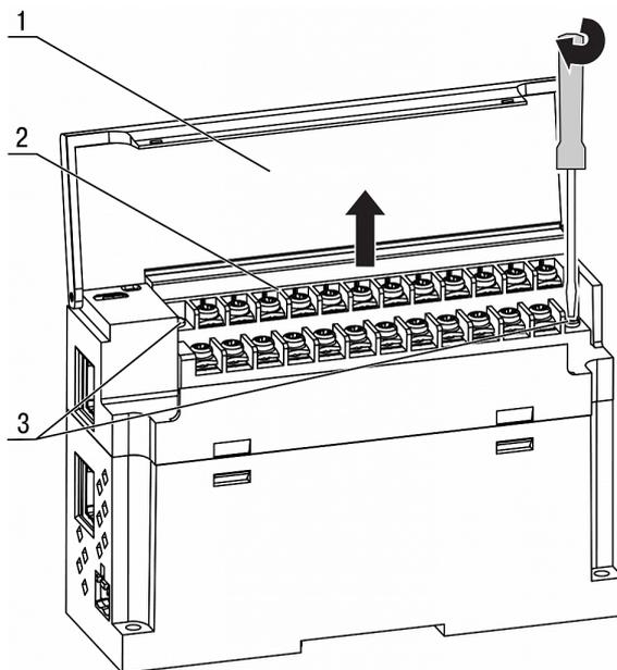
**Рисунок 8.1 – Отсоединение клемм**
