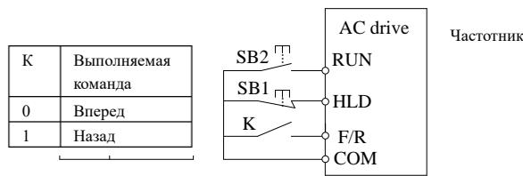
Рис.6-16 Трехпроводной режим управления 2
