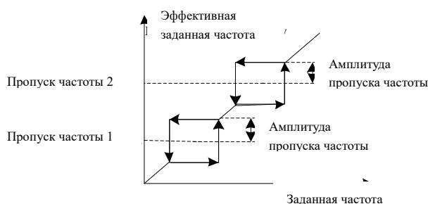
Рис. 6-5 Пропуск частот
