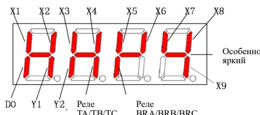
Рис. 6-28 Схема отображения текущего состояния статуса клемм
