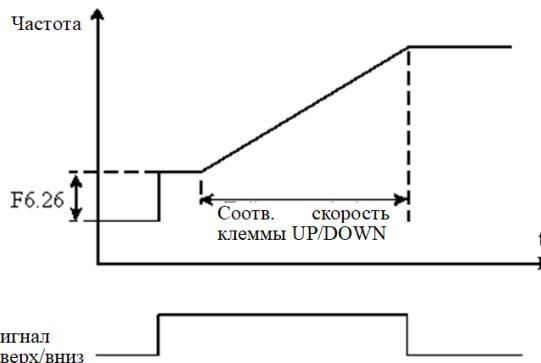
Рис.6-19 Начальный шаг клеммы UP/DOWN
