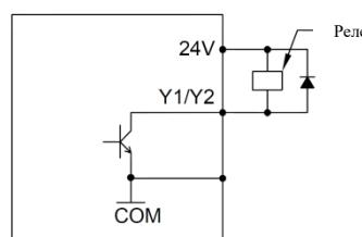
Рис. 3-12 Способ подключения внутреннего источника питания +24 В
