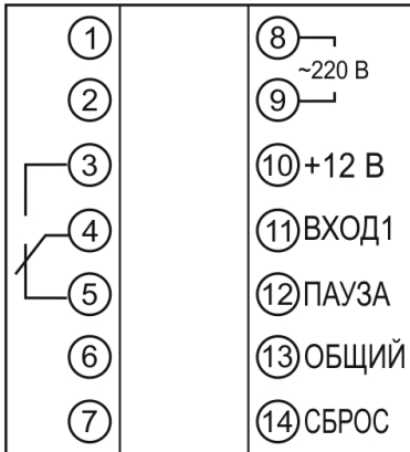
Рис. 8 Схема подключения ARCOM-TC-D77 с реле
