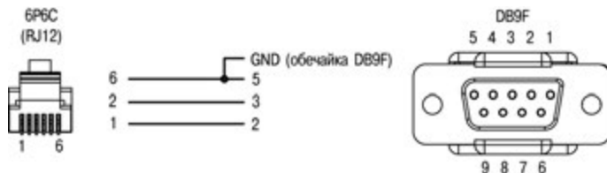
Рисунок В.5 – Кабель KC2 для подключения ПЛК100.ТЛ к панелям ИП320, СП270 и СП3хх (порт RS-232 Debug)
