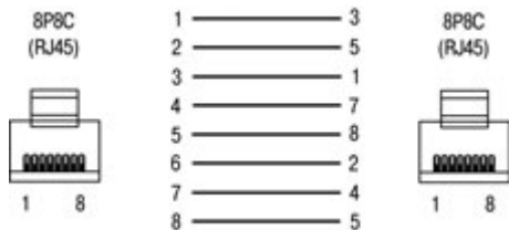
Рисунок В.7 – Кабель Ethernet crossover
