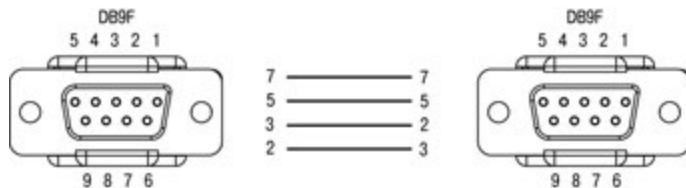
Рисунок В.6 – Кабель KC4 для подключения ПЛК100.ТЛ к панелям ИП320, СП270 и СП3хх (порт RS-232 Download)
