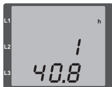
Рис. Показатель счетчика часов работы Счетчик времени работы устройства UMG 96RM-E показывает значение 140,8 ч. Это соответствует 140 часам и 80 промышленным минутам. 100 промышленных минут соответствуют 60 обычным минутам. Соответственно, в этом примере 80 промышленных минут равны 48 обычным.
